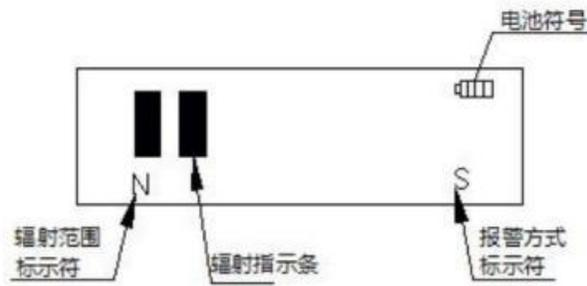
图 2.2.1 剂量率测量界面介绍
