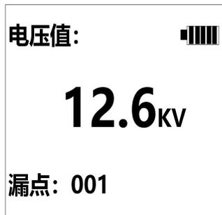
在测量界面下,按CLR/ESC键可清除漏点个数,按“^”、“v”键,可快速调整高压值。
