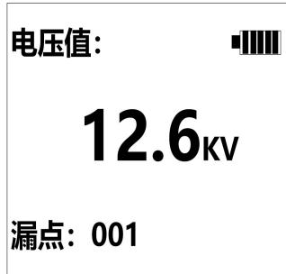
在测量界面下，按CLR/ESC键可清除漏点个数，按“”、“”键，可快速调整高压值。
